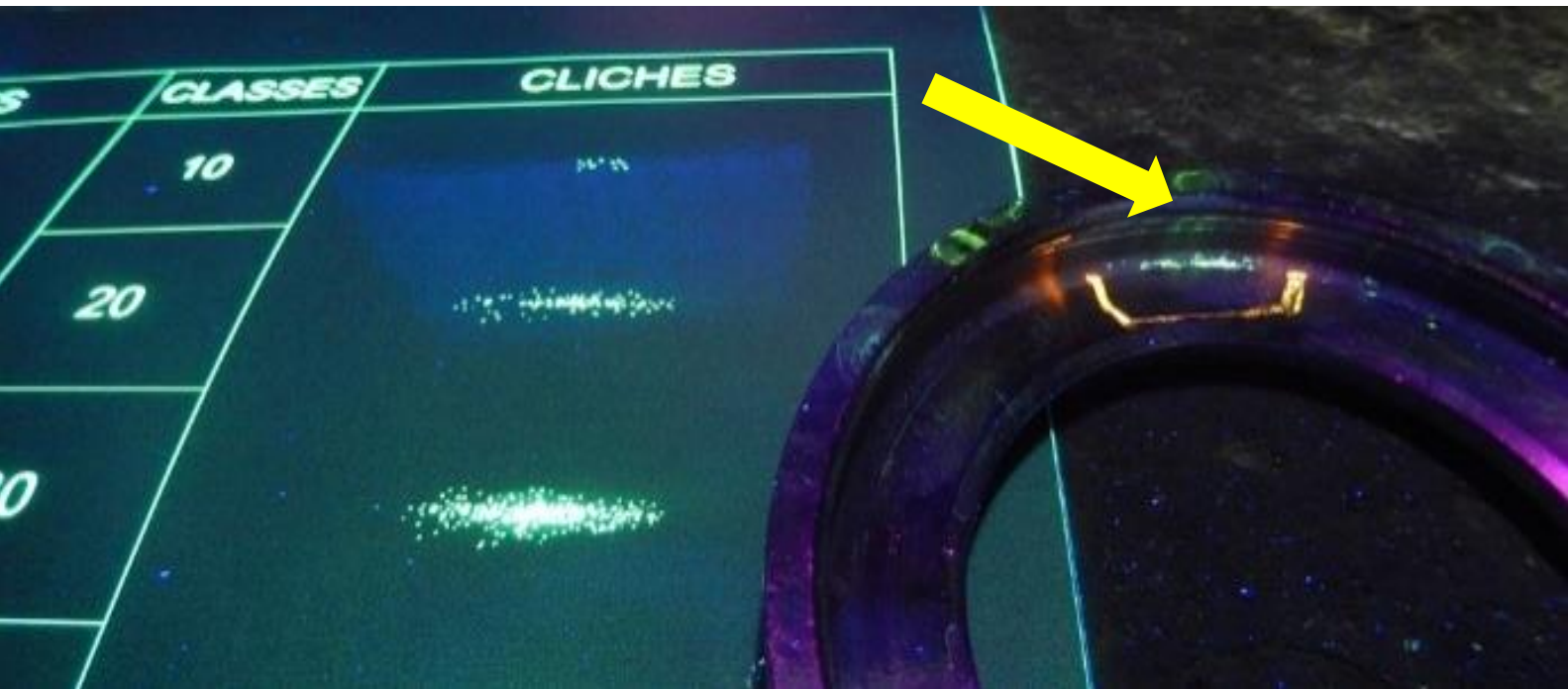
Evaluation et marquage Sous UV par rapport Aux critères du client
