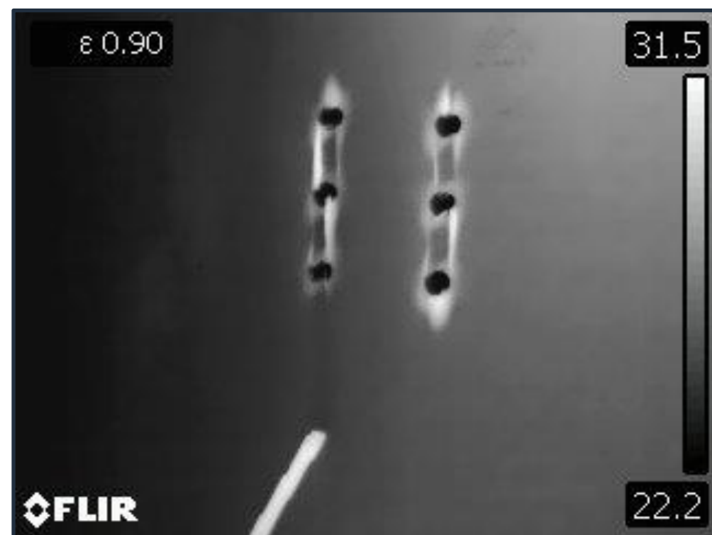
Délaminage après perçage
