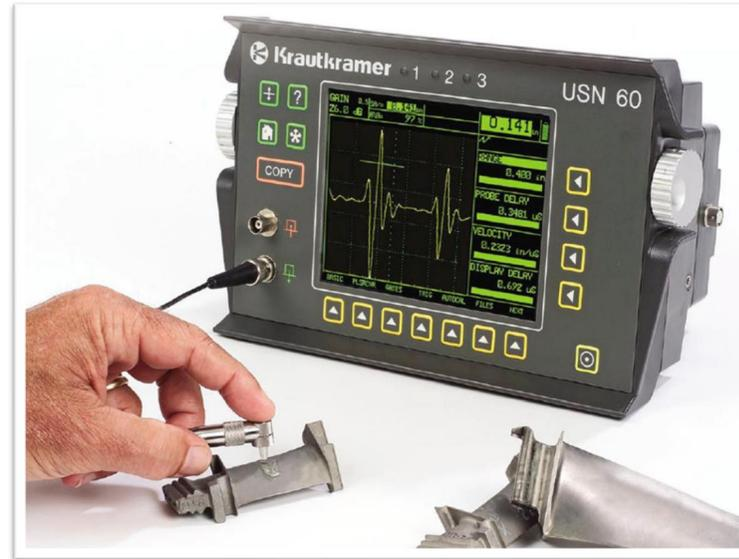
Contrôle Erosion / Corrosion
